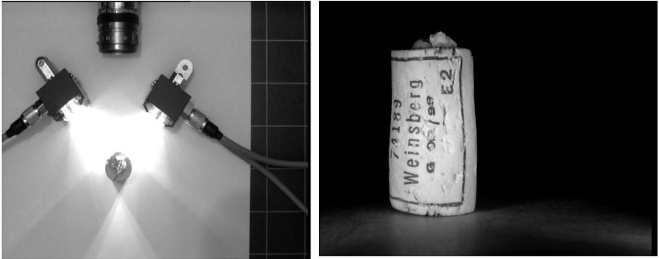
图8 左：一个简单的实验室模型显示了两个VarioFlash模块就能如此简单地产生一个与环形灯相同的效果。如果需要照亮更大的区域，只需将若干VarioFlash模块如图2一样菊形连接起来即可。
