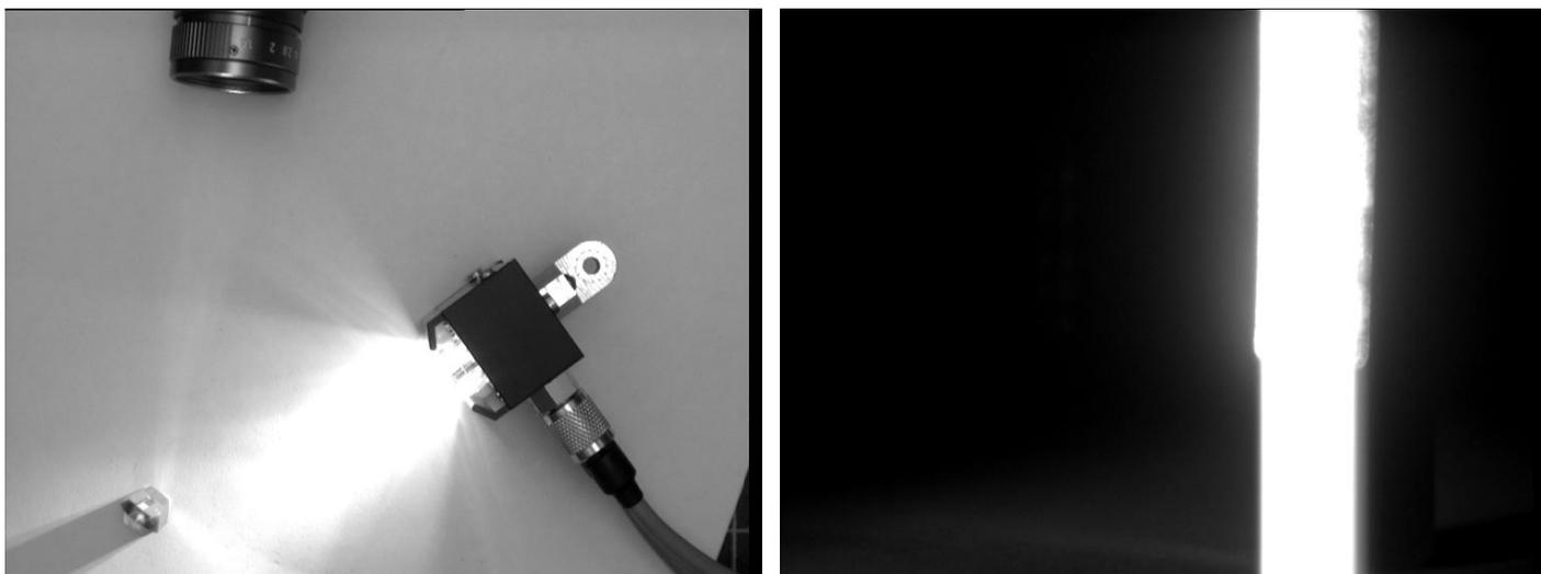
图9 左：如果目标体积小，我们只需要一个VarioFlash。但如右图所示，图像远不能让人满意。原因就是目标物体表面为金属且反光。相机没有看到物体本身，相反它看到的只是光源的镜像（在LED模块情况下）。结果得到的图像就只是一片极亮的区域。而该问题的解决方法由图10示出。
