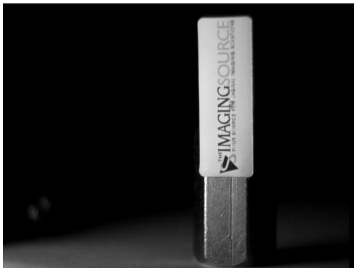
图10：使用漫射光可以解决图9中所示的反射光问题。这种方法需要使用一个表面毛糙的白色反射器来照亮目标物体。在实验中我们使用的是一张纸。VarioFlash模块必须直接照射到这张白纸上，而白纸将生成漫射光从而照明金属物体。与图9相比，此方法的效果明显不同。图9中金属物体后面的阴影就是光线直射的结果之一。但在上图中这些阴影完全消失。阴影是随反射一起出现的。
